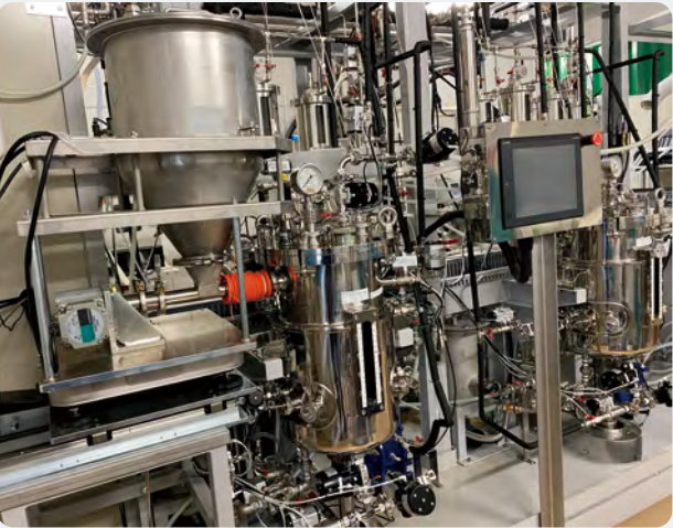
〈ベンチテストプラント機〉 Green Earth Institute株式会社Green Earth 研究所(木更津市)にて、2025年3月よりベンチスケール設備が稼働。(写真提供元: Green Earth Institute株式会社) バイオエタノール製造時のエネルギー消費量は、紙製品製造時と比較し、約40%抑制可能(当社試算)
