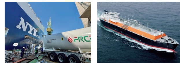
ISOコンテナによるLNGバンカリング
