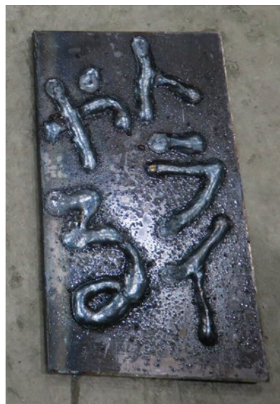
半自動溶接で文字を施した鋼板
