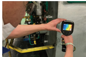
熱処理炉の表面温度を測定 (榛名工場)
