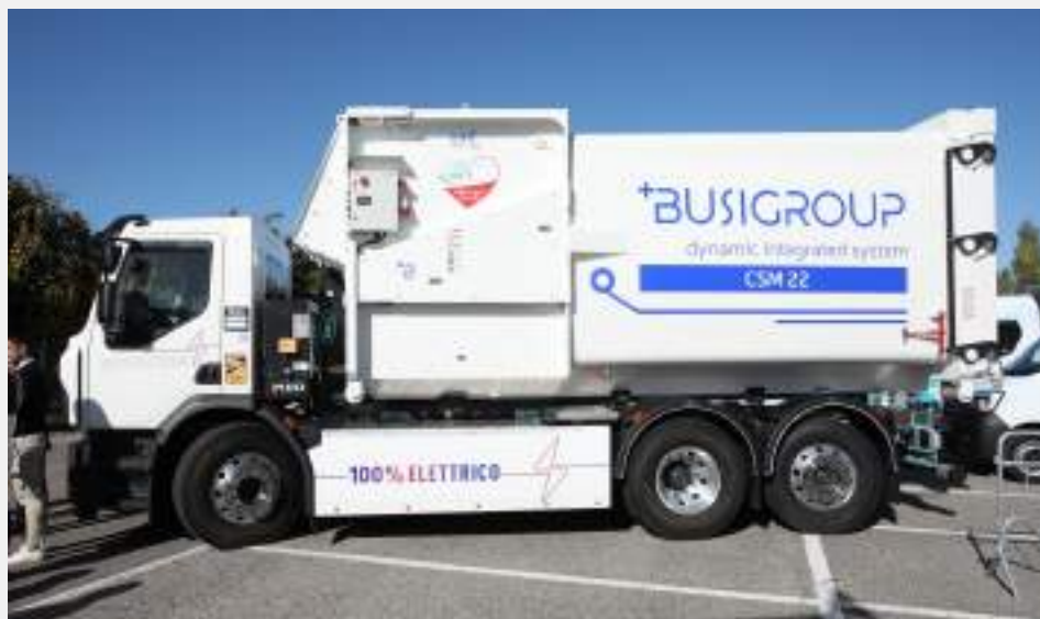
D-Wide elettrico con allestimento scarrabile MEC e dotato di compattatore monopala BTE
