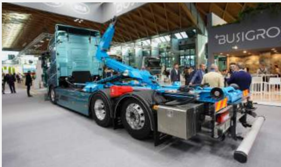
Attrezzatura Scarrabile SLK 267 allestita su un Volvo FH carro pesante 6X2 Electric 100% elettrico (per l'Italia si tratta del primo carro pesante Volvo 44t e con cabina letto allestito con un sistema scarrabile)
