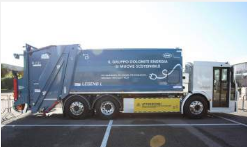
Sistema per la raccolta e compattazione rifiuti a carico posteriore Legend L 20 allestito su VOLVO FE LEC 6x2 Electric e in dotazione a Dolomiti Ambiente
