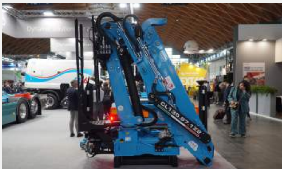
Nuova Gru Caricatore CL.135.97.1Z2 caratterizzata da migliorie come la riduzione di peso (~ 400 Kg) e una maggiorazione degli angoli di rotazione e delle portate
