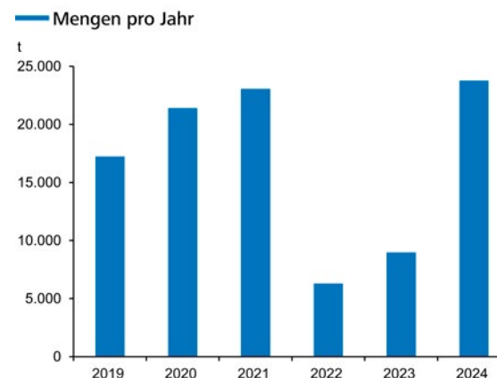
(20) VERWENDUNG VON KLÄRSCHLAMMASCHEN ALS DEPONIEERSATZBAUSTOFF
