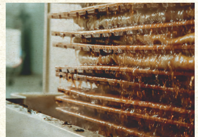
Mit einem Druck von bis zu 270 bar entsteht der Heilpflanzensaft.
