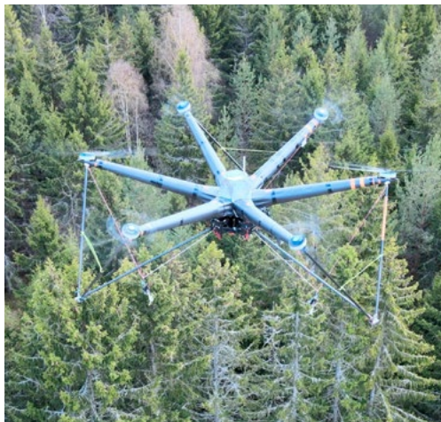
AirForestry utvecklar teknik för gallring med hjälp av drönare.
